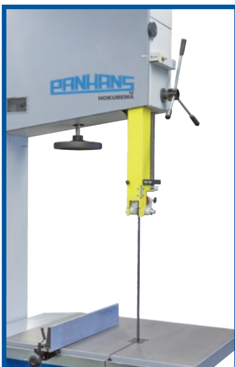
Extension de la hauteur de coupe - 220 mm > Rapid 600/700/800/900 - 400 mm > Rapid 700/800
