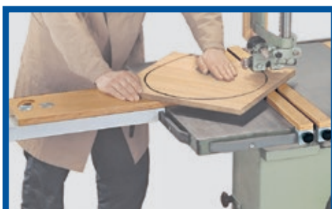
Guide circulaire - Kreisfix en combinaison avec les rails de fixation
