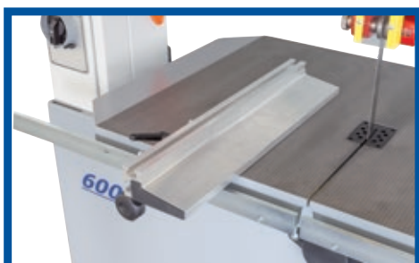
9 Règle butée pivotante debout pour les pièces larges/hautes, à plat pour les petites pièces.
