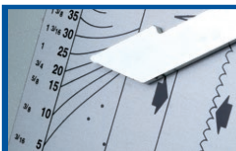
7 Affichage de la tension de lame avec fenêtre témoin, pour le réglage de la tension recommandée
